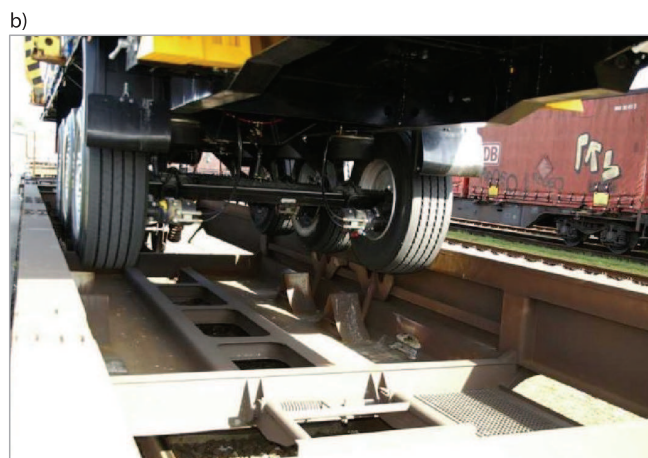
Rys. 1. Charakterystyczne elementy wagonu kieszeniowego [10]: a) podpora siodłowa, b) zagłębiona podłoga
