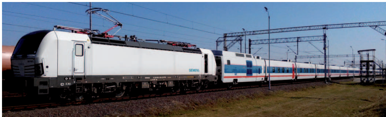
Rys. 2. Skład wagonowy TALGO F063 na torze doświadczalnym w Żmigrodzie [fot. M. Lalik]
