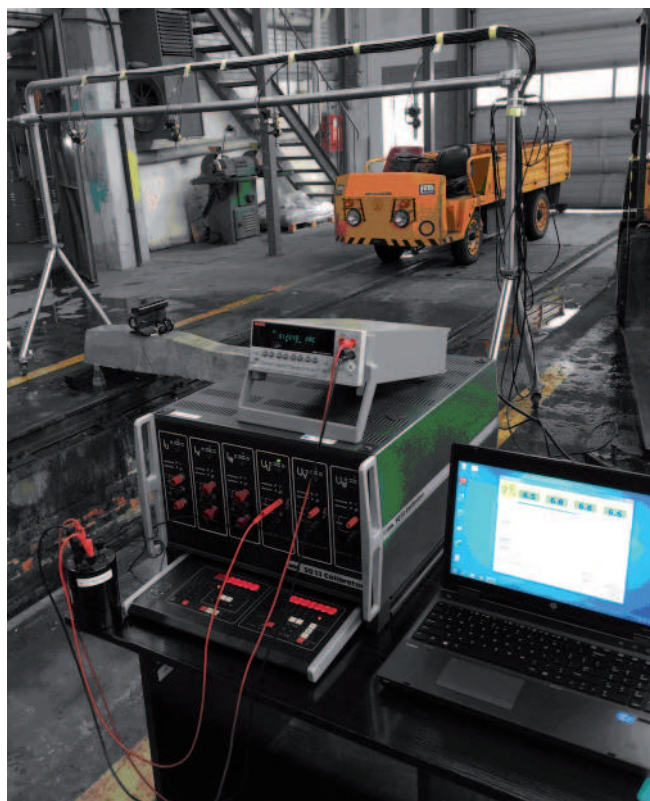
Rys. 6. Stanowisko do badania rezystancji podkładów [fot. M. Kucińska]
