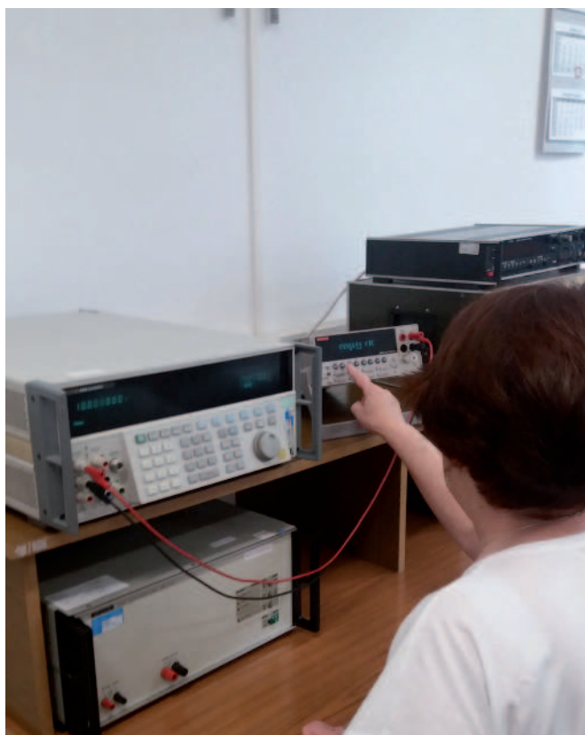
Rys. 2. Stanowisko do pomiarów napięcia stałego i przemiennego, prądu stałego i przemiennego oraz rezystancji [fot. W. Surmak]
