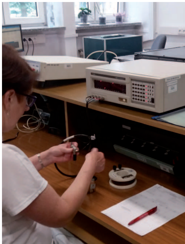
Rys. 3. Stanowisko do pomiarów rezystancji AC, pojemności i indukcyjności [fot. W. Surmak]
