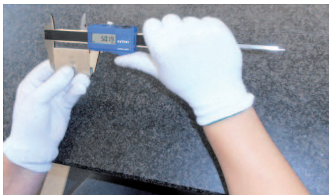
Rys. 8. Wzorcowanie suwmiarki przy użyciu płytek wzorcowych klasy 1 [fot. A. Aniszewicz]
