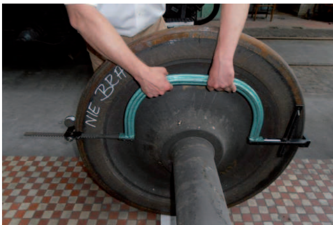
Rys.11. Pomiar za pomocą specjalnego przyrządu pomiarowego średnicy na okręgu tocznym tarczy koła zestawu kołowego wymontowanego z wózka [fot. C. Mrzewiński]
