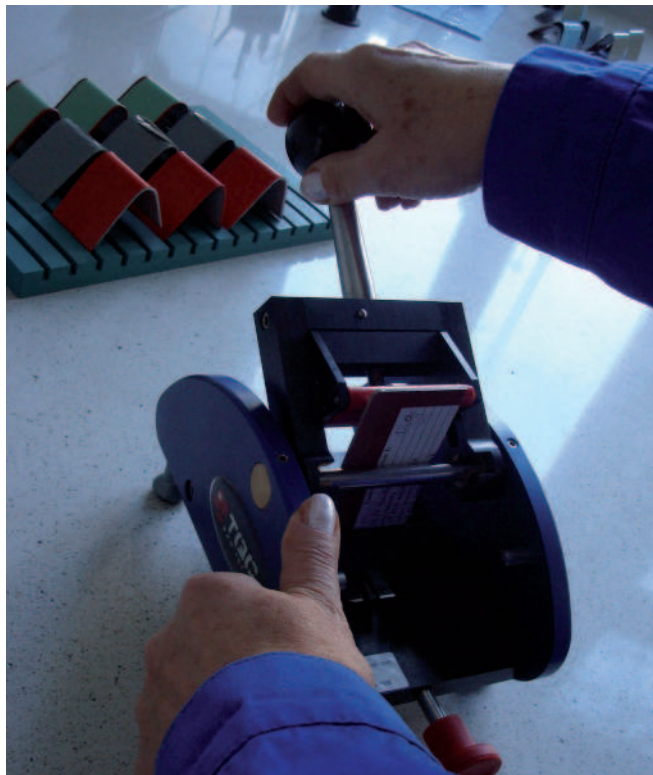
Rys. 4. Badania fizyko-mechaniczne powłoki malarskiej według PN-EN ISO 1519:2012 [fot. z archiwum Laboratorium]
