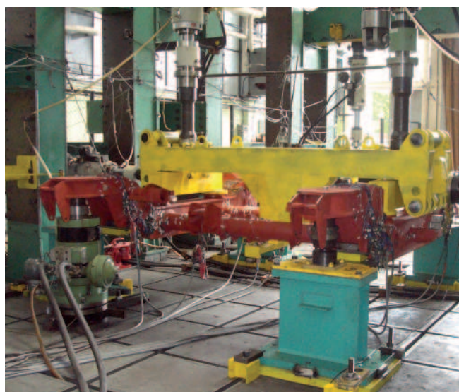
Rys. 3. Badania wytrzymałościowe ramy wózka [fot. archiwum Laboratorium]
