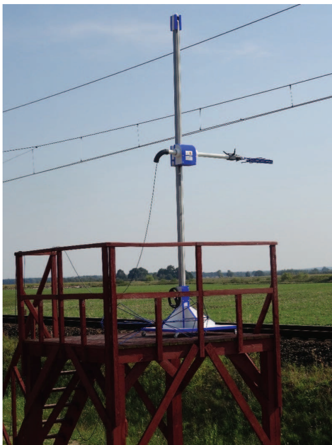
Stanowisko do badań kompatybilności elektromagnetycznej na Okręgu Doświadczalnym IK w Żmigrodzie [fot. archiwum Laboratorium Badań Taboru]
